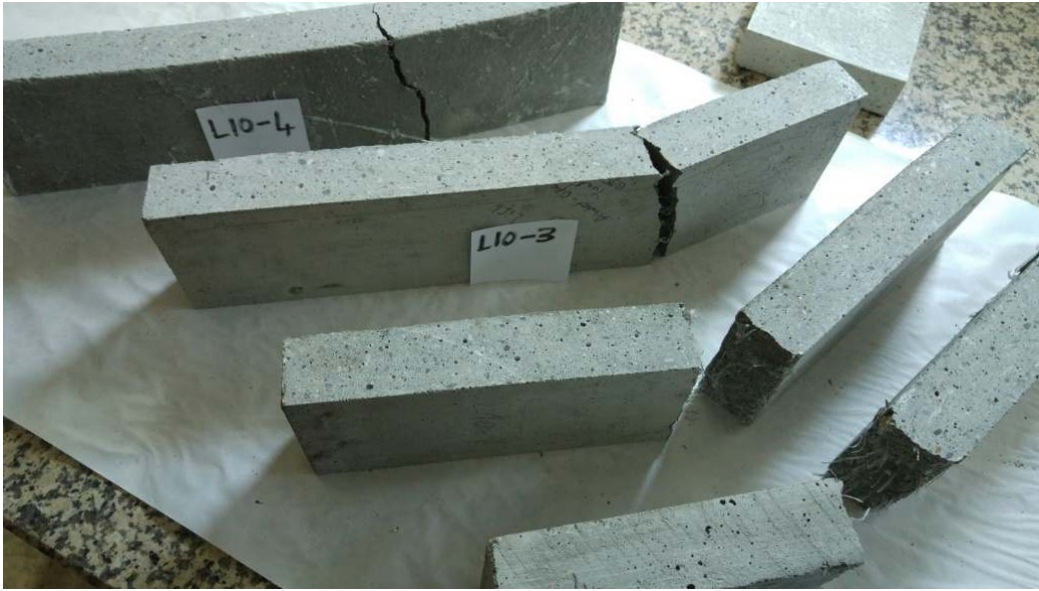
Şekil 7. Test edilen 10 kg/m 3 lif katkılı (L10) deney numunelerinin kırılma biçimleri
