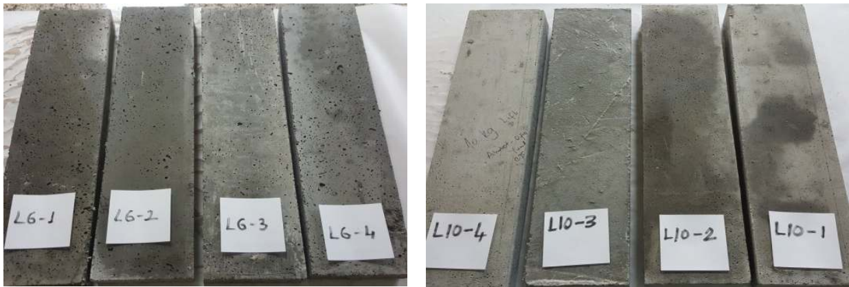
Şekil 2. Üretilen 6 kg/m 3 lif katkılı (L6) ve 10 kg/m 3 lif katkılı (L10) deney numuneleri
